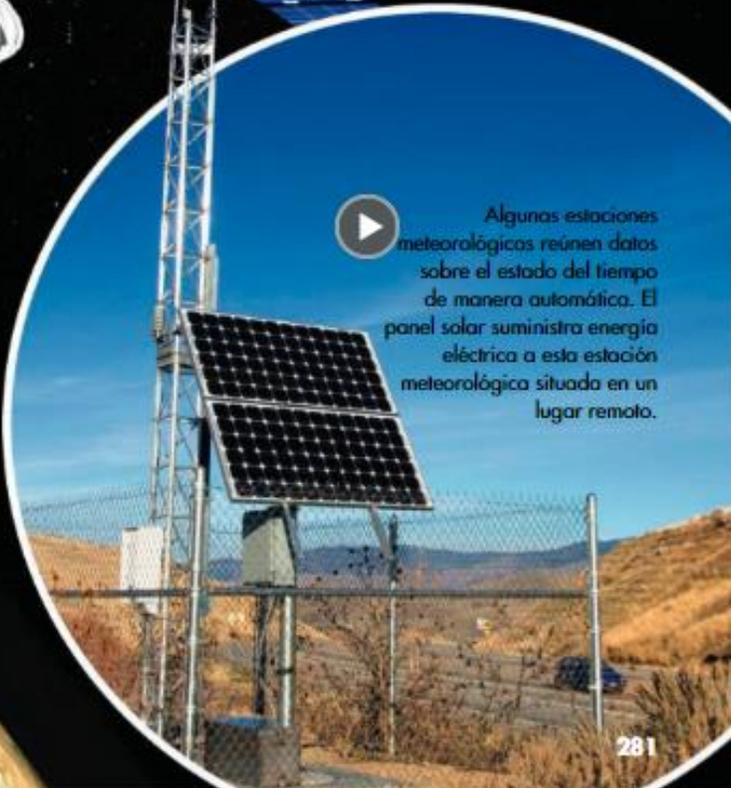
▶ Algunas estaciones meteorológicas reúnen datos sobre el estado del tiempo de manera automática. El panel solar suministra energía eléctrica a esta estación meteorológica situada en un lugar remoto.
