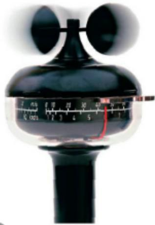
▶ Los meteorólogos miden la velocidad del viento usando un instrumento llamado anemómetro.
