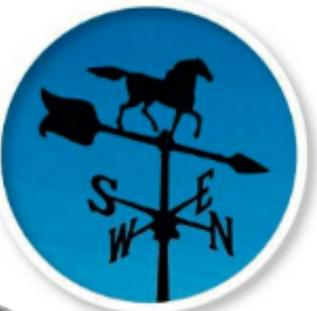
▶ La dirección del viento puede observarse con una veleta. La flecha apunta hacia la dirección de la que viene el viento. Es decir, apunta hacia el viento. La veleta de abajo muestra que hay viento del norte.
