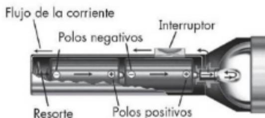
El circuito eléctrico de la linterna tiene dos pilas, una bombilla (una resistencia) y un interruptor. ¿Cómo se ve afectada la electricidad del circuito de la linterna al apagar el interruptor?
